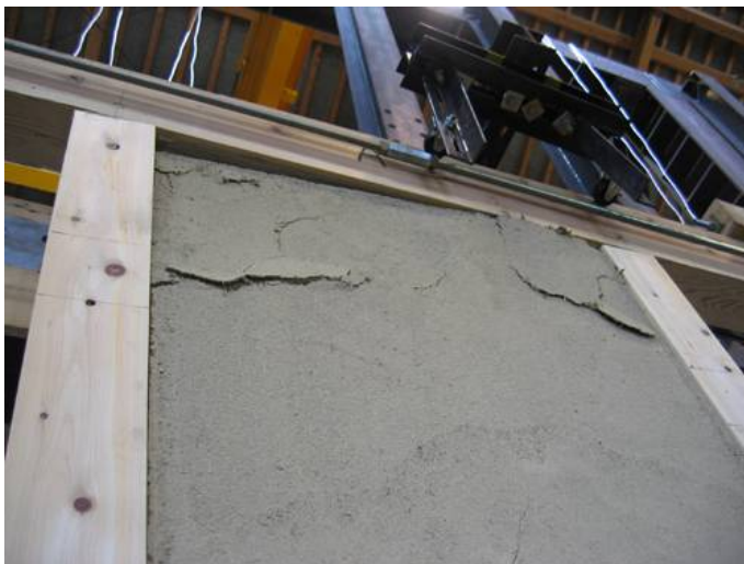
近くの山の木で家をつくるスクール 水平加力実験 (岐阜県森林アカデミー)
